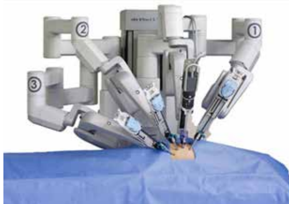
Figura 10.3 - Le 4 braccia mobili del robot nella loro collocazione al tavolo operatorio
