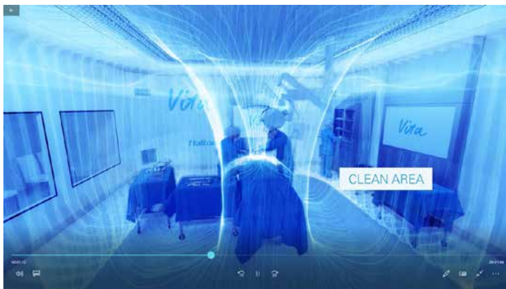
Figura 11.10 - Esempio di DFU con diffusori perimetrali a getto per il convogliamento dell'aria verso il centro dell'area critica
