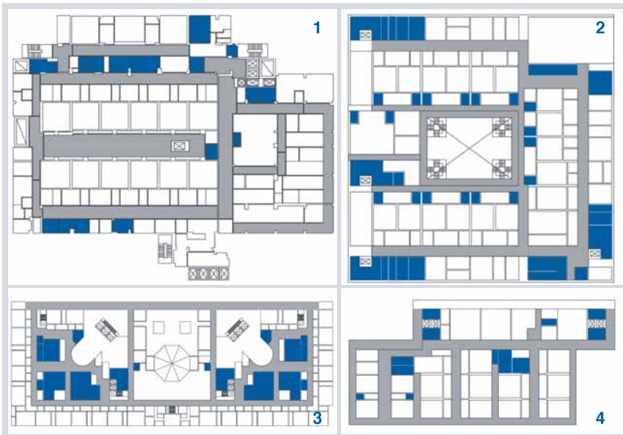
Figura 8.30 - Confronto del dimensionamento dei percorsi e degli spazi adibiti a deposito in quattro ospedali. 1: Policlinico universitario A. Gemelli Roma (vedi anche fig.8.24). 2: Ospedale Papa Giovanni XXIII Bergamo (vedi anche fig. 8.6). 3: Ospedale Delta Bruxelles (vedi anche fig.8.26). 4: Ospedale Santo Stefano Prato (vedi anche fig.8.22)
