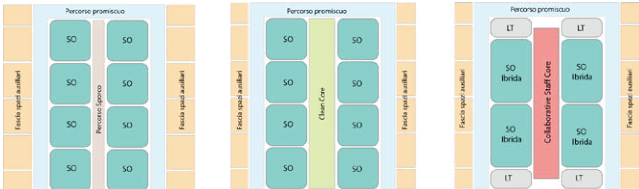
Figura 9.24 - Evoluzione del modello funzionale del Blocco operatorio: a) Modello funzionale 'centrato' sulla separazione dei percorsi, b) Modello funzionale 'centrato' sulla logistica dei presidi medico chirurgici, c) Modello funzionale 'centrato' sulla collaborazione degli specialisti e l'interazione dello staff
