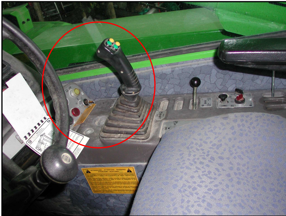
Fotografia 29 – Comandi del braccio telescopico tipo Joystick
