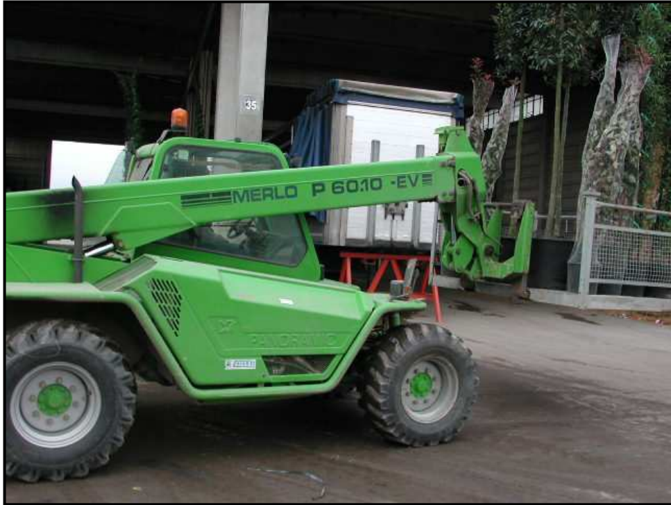
Fotografia 26 - Visibilità posteriore insufficiente
