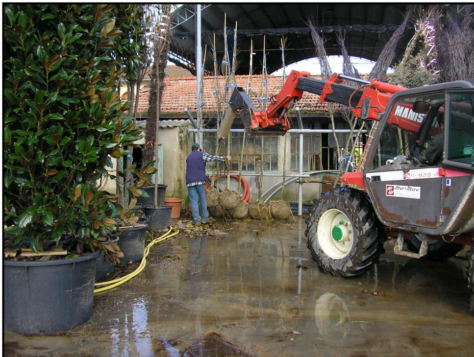
Fotografia 28 - visibilità insufficiente nella zona di operazione del lavoratore a terra
