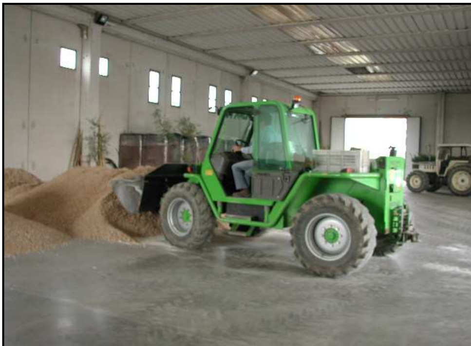
Fotografia 17 - Carrello elevatore a braccio telescopico con pala caricatrice.
