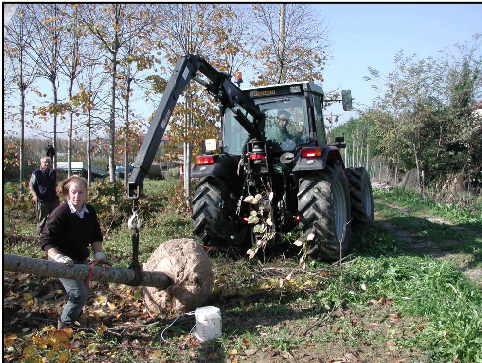
Fotografia11- Gru su trattore, estirpazione piante in pieno campo.
