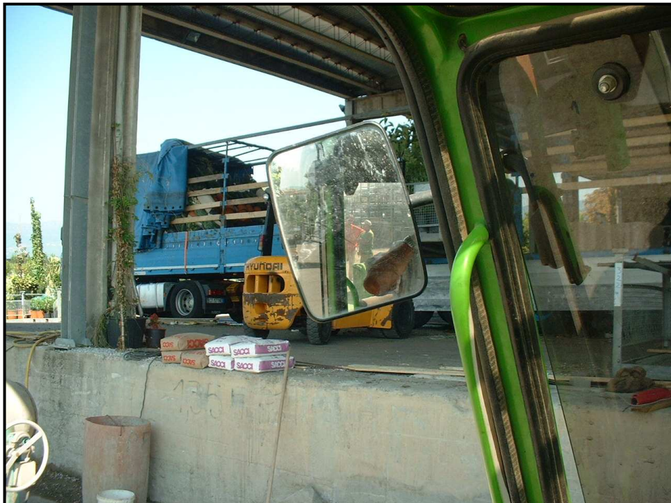
Fotografia 26 - Visibilità posteriore insufficiente
