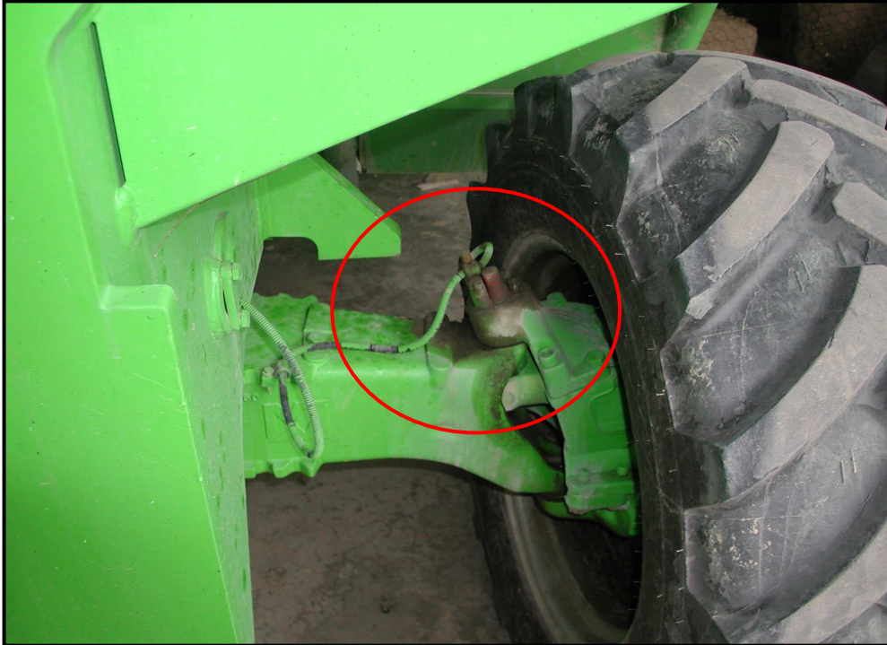
Fotografia 31 – Sensore del dispositivo antiribaltamento
