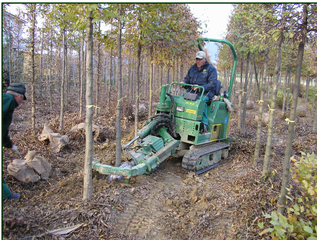
Fotografia 5 - Estirpazione di una pianta con Zollatrice
