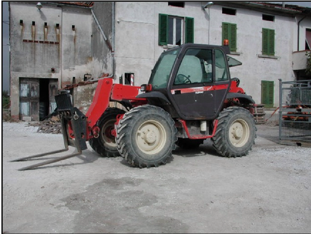
Fotografia 14 – Carrello elevatore a braccio telescopico
