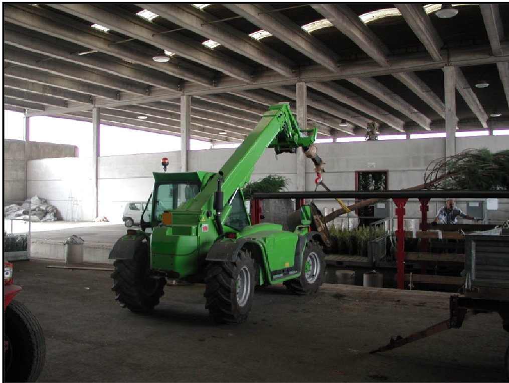
Fotografia 15 - Carrello elevatore a braccio telescopico con installato il braccetto grù.
