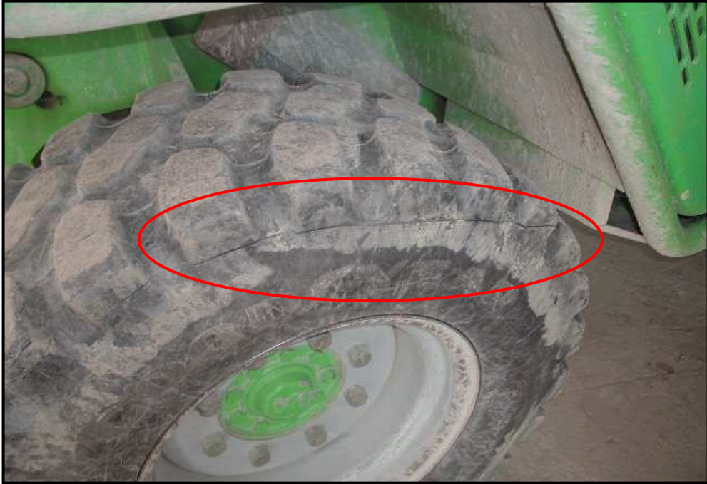
Fotografia 21 - Utilizzo del mezzo con pneumatico danneggiato da un profondo taglio sul fianco
