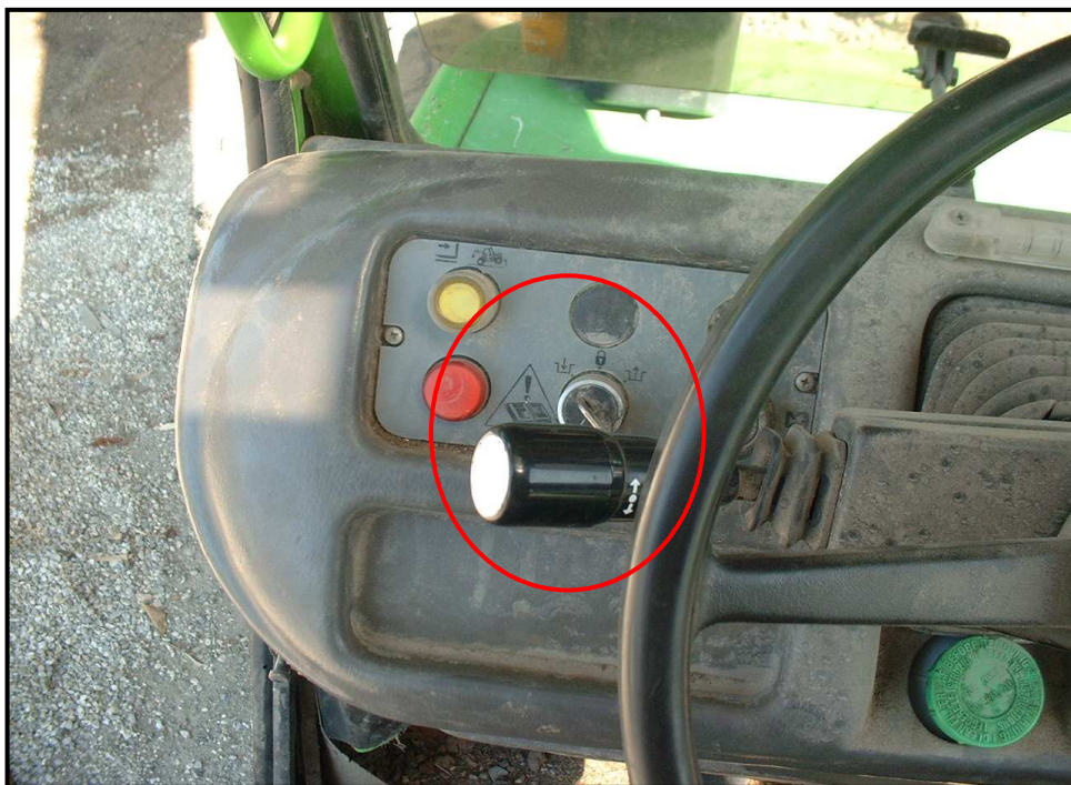
Fotografia 30 - Chiave per il disinserimento del dispositivo antiribaltamento
