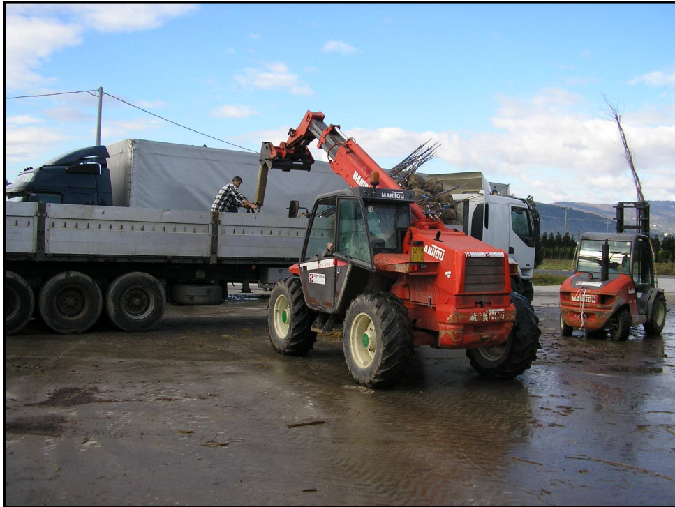
Fotografia 28 - visibilità insufficiente nella zona di operazione del lavoratore a terra
