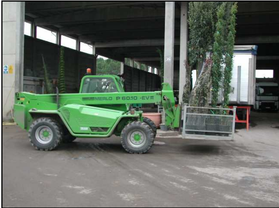
Fotografia 17 - Carrello elevatore a braccio telescopico con pala caricatrice.
