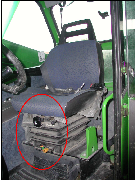
Fotografia 22 - Regolazioni sedile di guida
